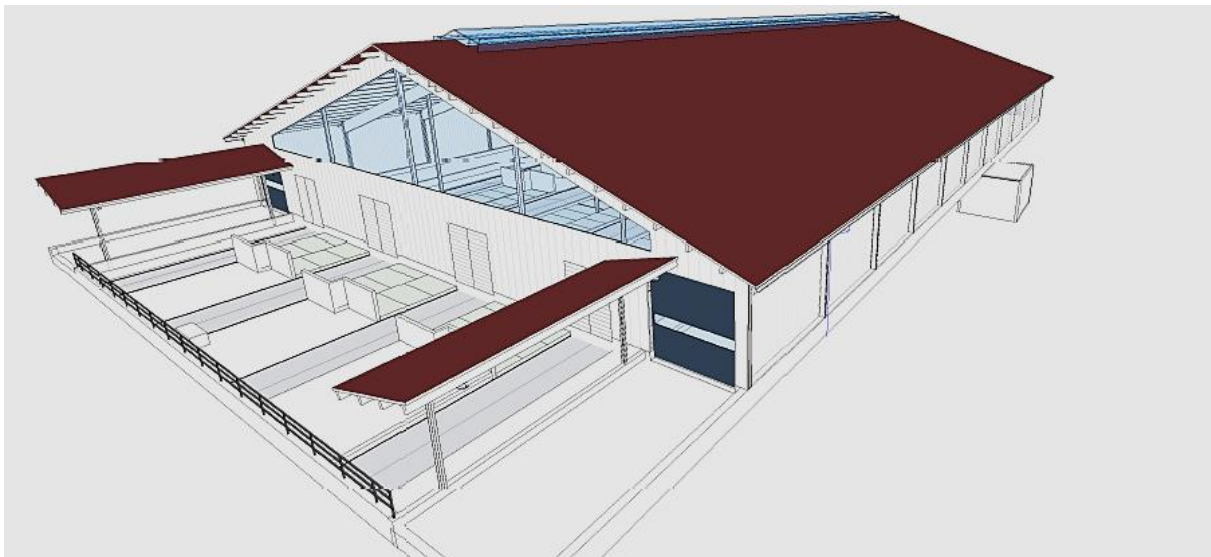
Abb. 5: Neubau des 6-reihigen Milchviehlaufstalls mit strukturiertem Laufhof
