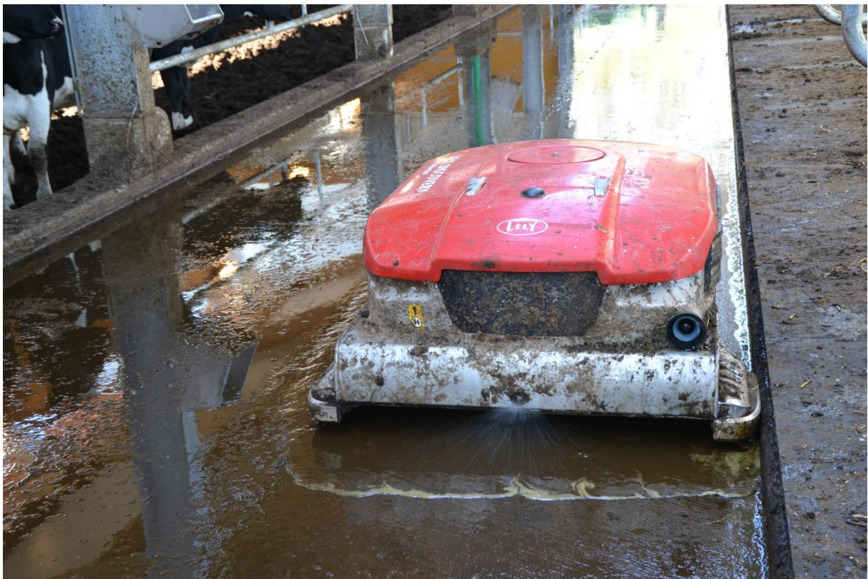
Abb. 9: Saug-Entmistungsroboter mit Bewässerungseinrichtung (Lely Collector)
