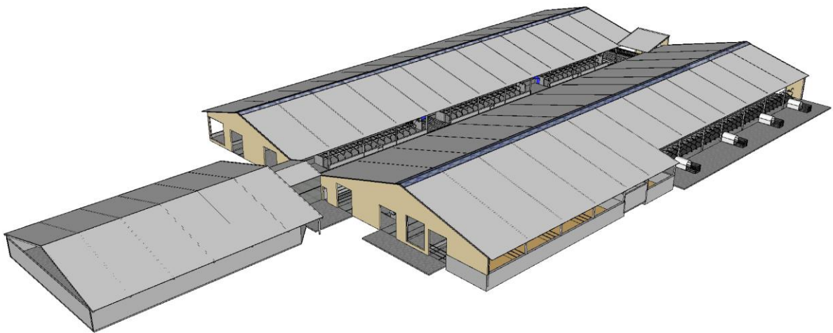
Abb. 5: Mehrhäusiger, sechsreihiger Milchkuhlaufstall mit integriertem, zentral angeordneten Laufhof und Melkkarussell
