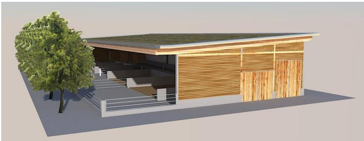
Abb. 6: Maststall als Zweiflächenstall mit Strohbuchten
