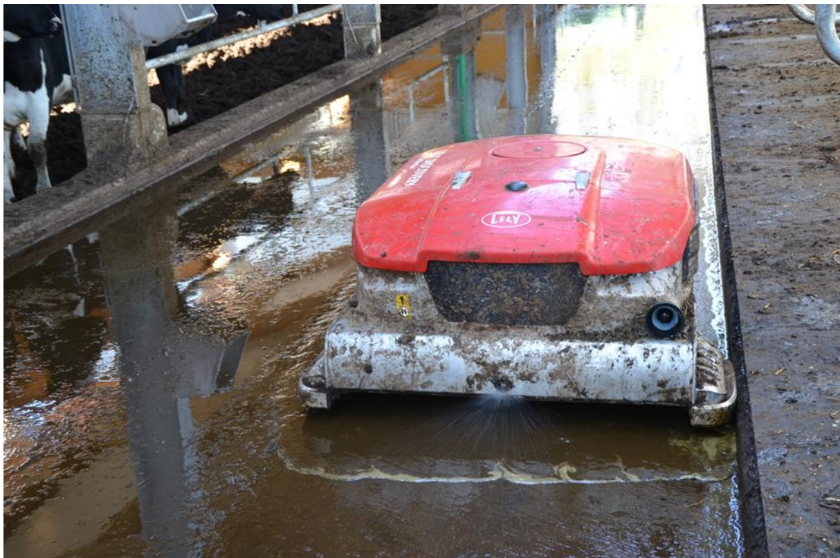
Abb. 10: Saug-Entmistungsroboter mit Bewässerungseinrichtung (Lely Collector)
