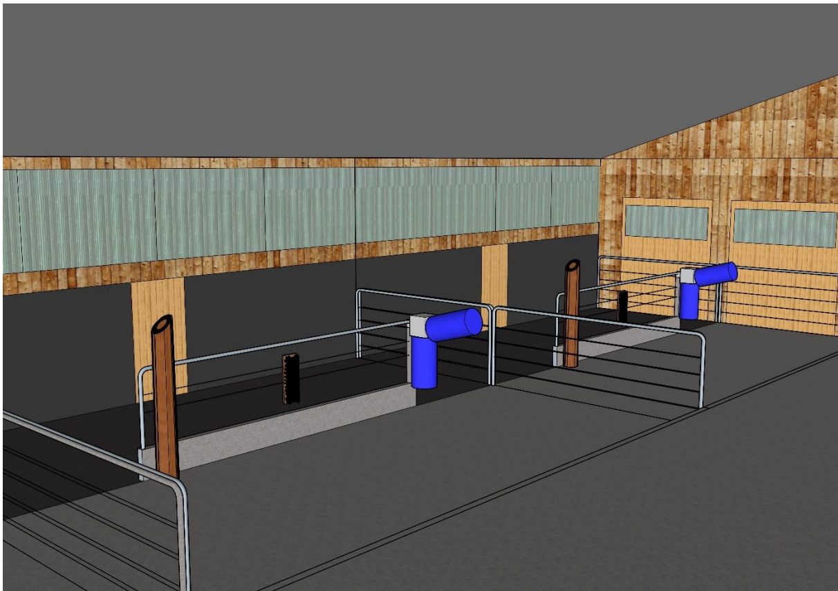
Abb. 11: Beispielhafte Installation von Scheuerelementen (Baumstämme, Bürsten) am Übergang zwischen Liege- und Fressbereich
