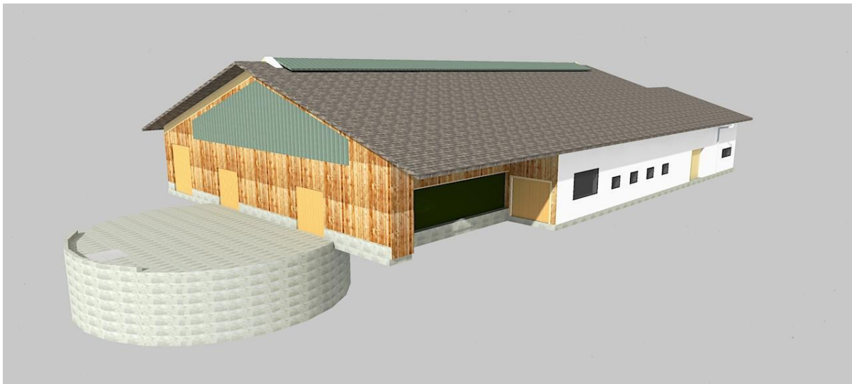
Abb. 5: Kompaktstall mit teilweise überbauter Güllegrube
